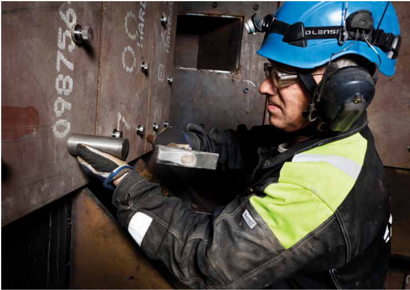
Montering av WRC Hylsskruv
