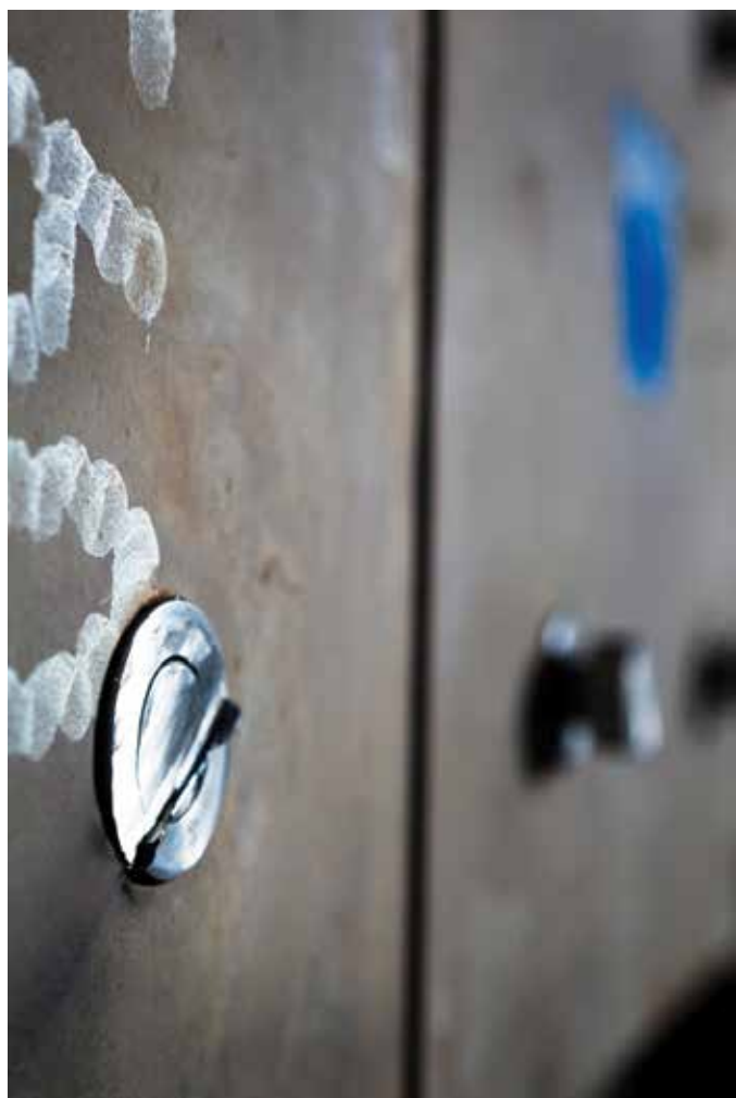
WRC Hylsskruv monteras från slitsidan
